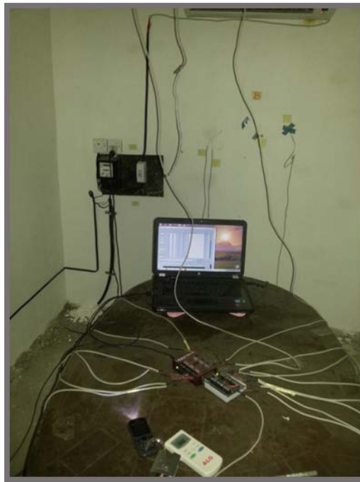
الشكل (6): صورة توزيع المتحسسات على السطح الخارجي لجدران غرف الاختبار
