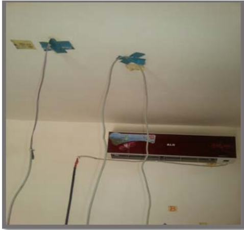
الشكل (8): صورة توزيع المتحسسات على السطح الداخلي لسقف غرفة الاختبار
