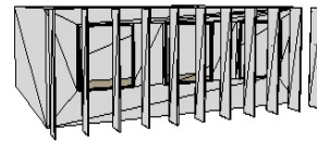
شكل (9) يوضح انواع الكاسرات المستخدمة ضمن التوجيهات الشرقية والغربية
